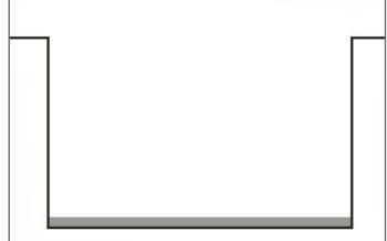
Définissez la zone de stationnement, puis décaissez la surface sur 45 à 50 cm. Cela comprend l'épaisseur des dalles qui est de 4 cm. Après avoir effectué le terrassement, assurez-vous de la perméabilité du support, puis mettre un géotextile anti-contaminant.
